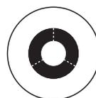
Tre maschere ad innesto separate da 120° per ridurre la portata ad un raggio di ca. 2,5 m per ogni arco di cerchio.
