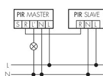
Aumento del campo d'azione con l'impiego di uno o più apparecchi Slave. Attenzione: L'apparecchio Master deve essere sempre montato in un posto dove la luce del giorno è minima.
